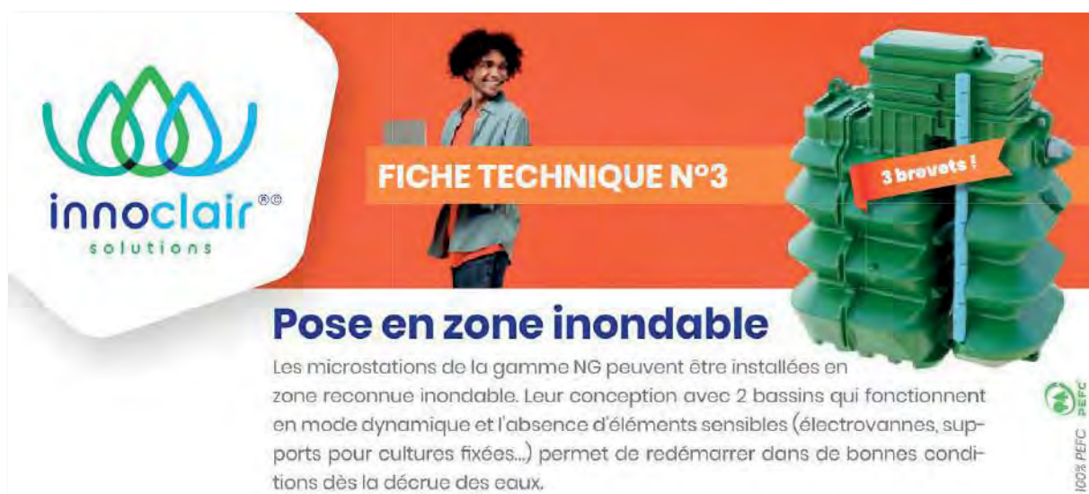
Figure 9 : Exemple de solution de microstation en zone inondable (innoclaire.fr)
